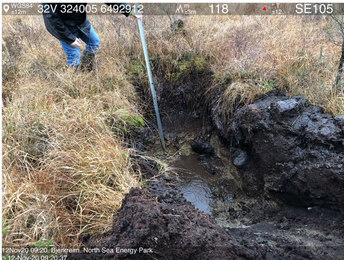
Figur 8. Prøvegrop PG3, ca. 1,3 m til mineralske masser.
