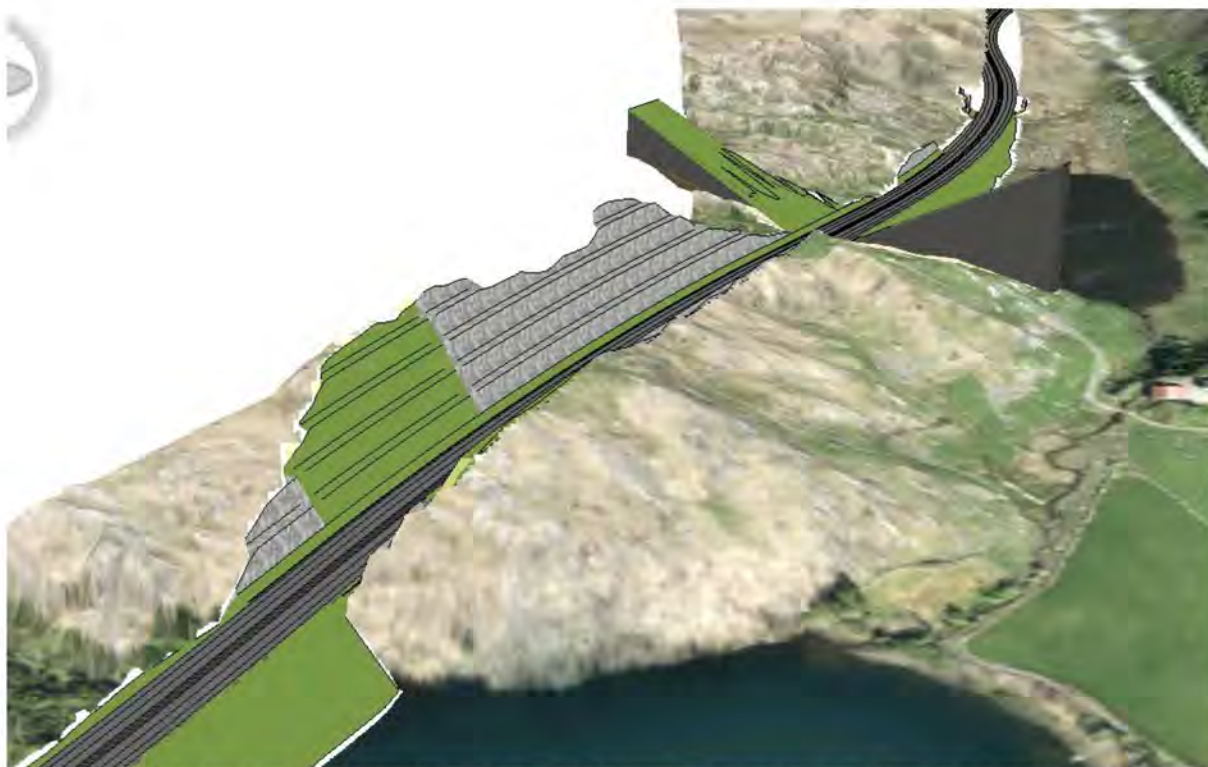
Figur 13 Forslag til veilinje der anlegget har blitt trukket lenger inn mot Holmafjellet og på nordsiden av Runatjørna.
